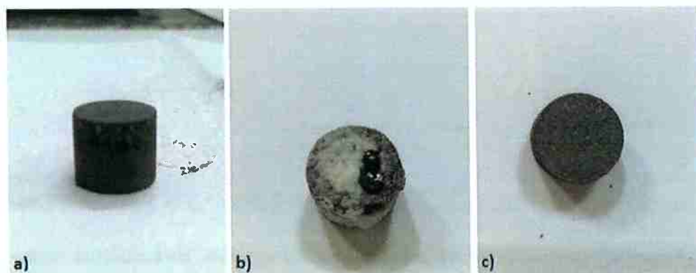
Figura 45: Fotografias: a) Corpo de prova sem tratamento térmico; b) Corpo de prova tratado em forno de micro-ondas sem a presença de nitrogênio durante 30 minutos à 1400°C; c) Corpo de prova tratado em forno de micro-ondas em atmosfera de nitrogênio durante 30 minutos à 1400°C.
