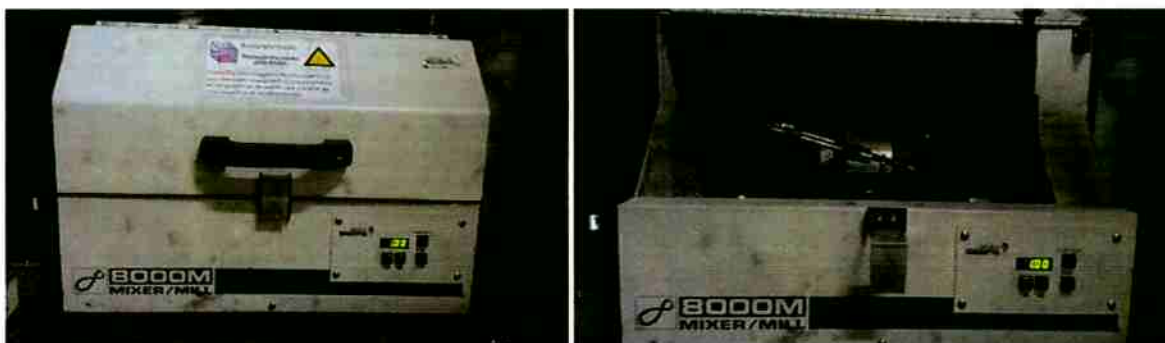
Figura 33: Moinho de alta energia SPEX-8000 mill utilizada durante os experimentos.
