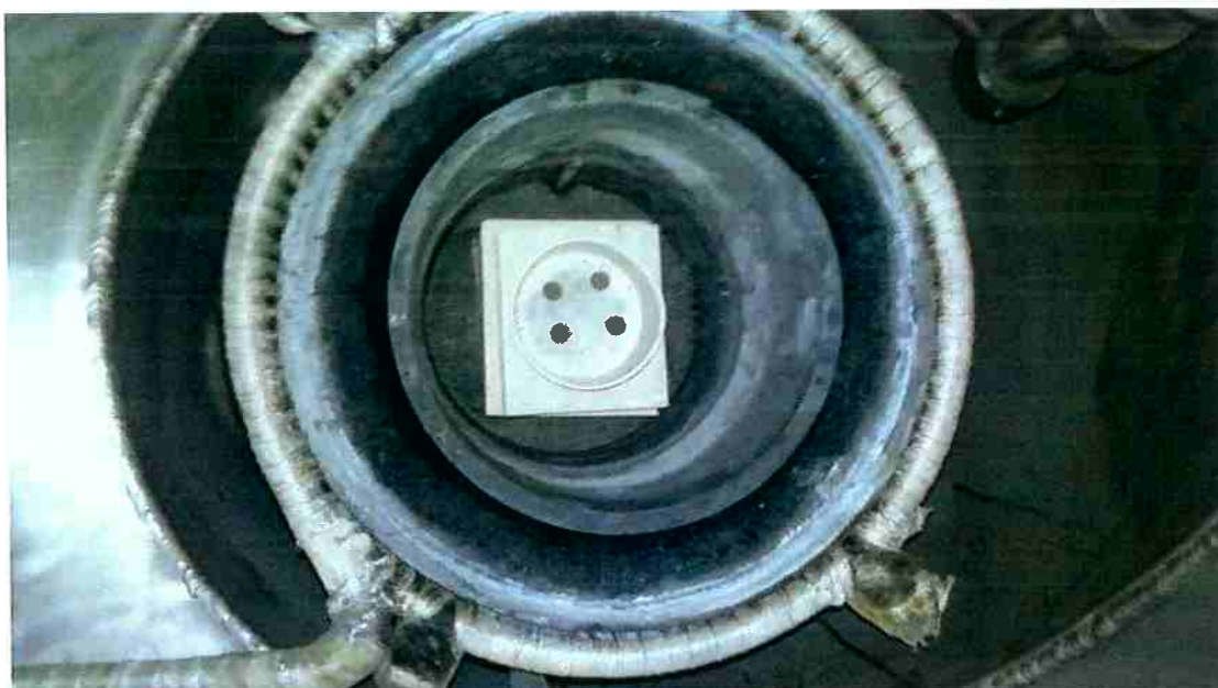
Figura 41: Montagem final do sistema interno com as amostras.
