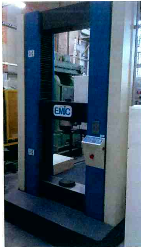
Figura 34: Máquina de Ensaio Universal Emic para a prensagem dos corpos de provas.
