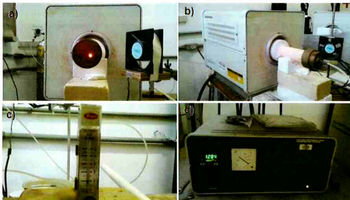
Figura 37: Fotografia dos equipamentos utilizados nos experimentos: a) e b) Forno tubular em funcionamento; c) Medidor de vazão de nitrogênio; d) Gerador com controle de temperatura.
