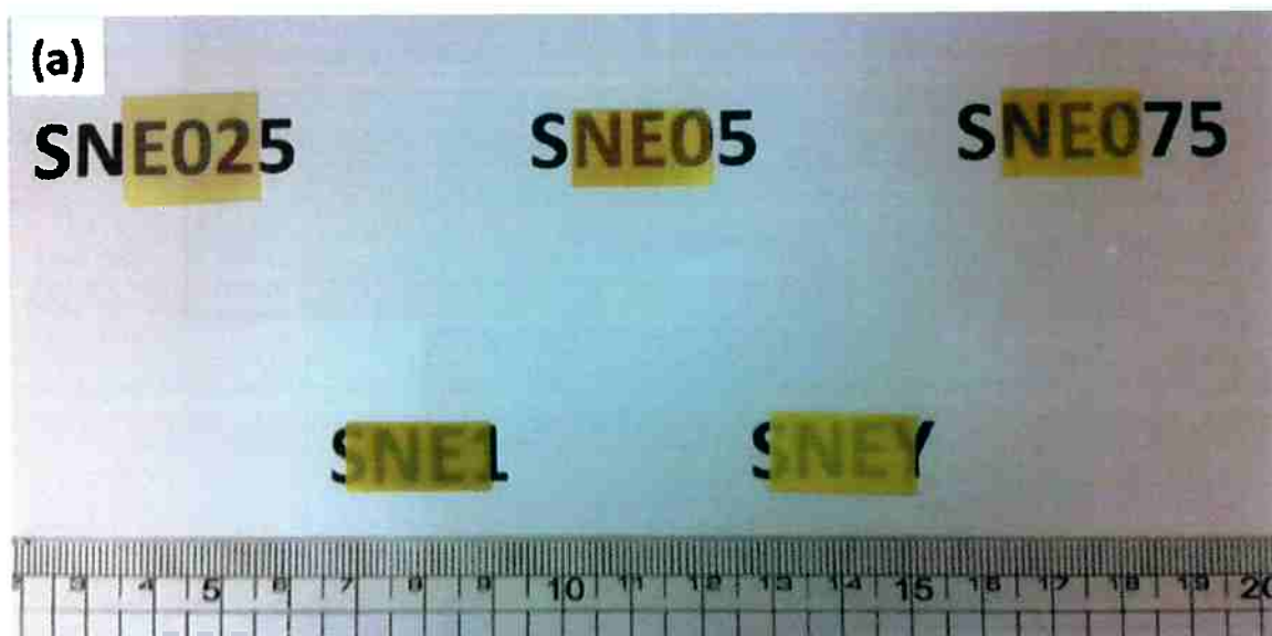
Figura 3: Placas 100 \mu\text{m} de espessura com diferentes transparências de Mg- \alpha -SIALON contendo fósforo. [3]
