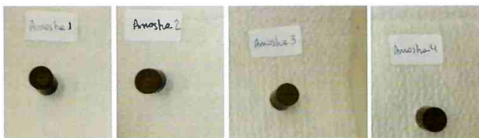
Figura 47: Corpos-de-prova antes da queima em forno de indução a vácuo.
